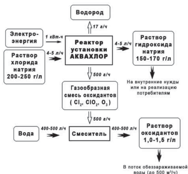
Рис. 2 Принципиальная схема технологического процесса работы установки АКВАХЛОР-500 производительностью 500 граммов оксидантов (в эквиваленте хлора) в час
