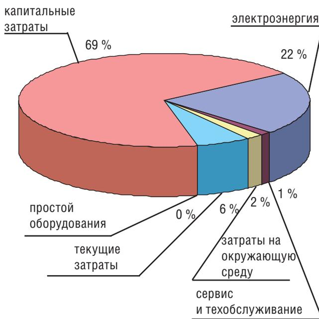
Рис. 12. Новое строительство объекта. Затраты жизненного цикла LCC блока биологической очистки с удалением азота и фосфора, где:
